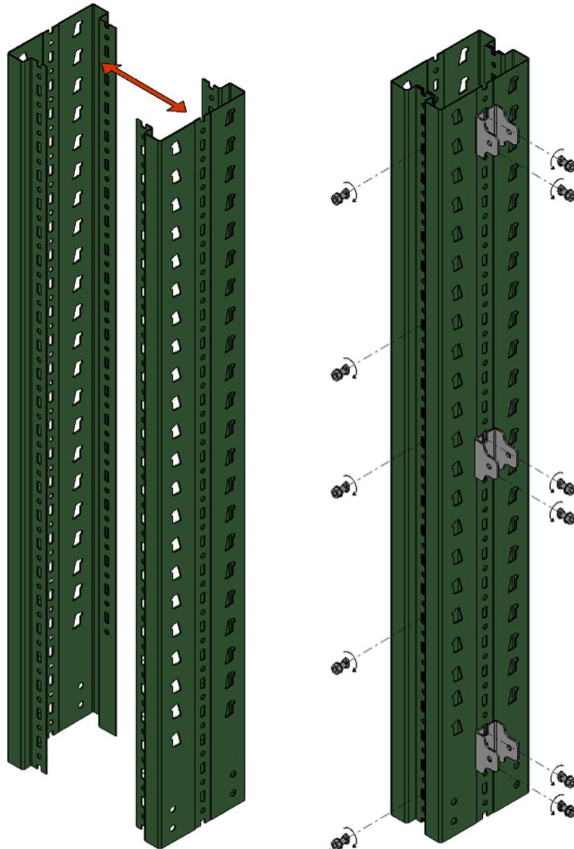
I bulloni M12 sulla colonna devono essere serrati con un coppia di serraggio di **87Nm**.
